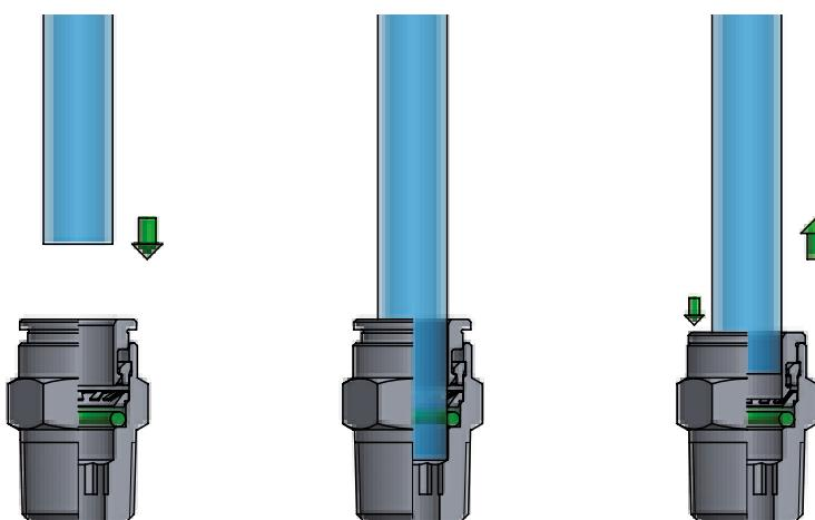
**!** Effettuato il collegamento, assicurarsi che il tubo inserito nel raccordo non sia sottoposto ad alcuna forza di trazione; è necessario inoltre rispettare durante il collegamento del tubo il raggio minimo di curvatura consigliato così come riportato nella sezione tubi di questo catalogo tecnico (vedi pag. 363).
